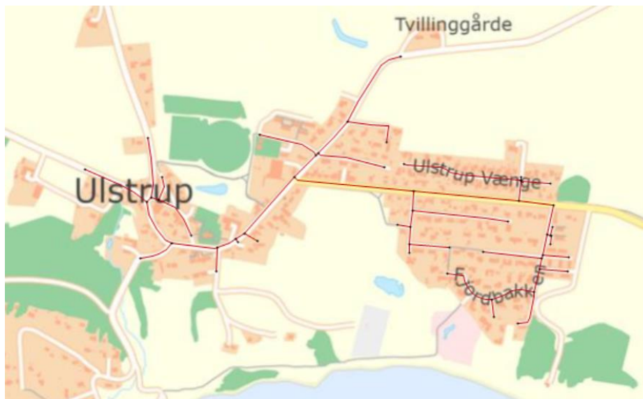
Figur 9: Oversigtskort over Ulstrup og de antagende hovedledninger i termonettet.
