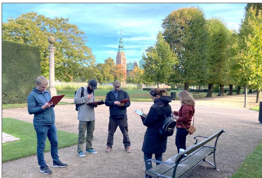
Figur 2 Lydlandsskabsmåling i en park i København udført af FORCE Technology som en del af FAMOS-projektet [19],[20]. Deltagerne besvarer på stedet en række systematiske spørgsmål om det oplevede lydlandskab på en iPad.
