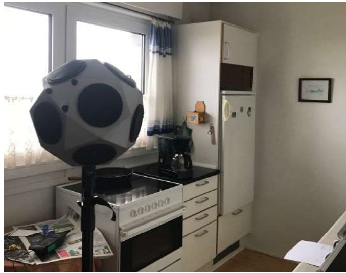
Venstre: Utætheder ved varmerør i lejlighed. Højre: Lydmålinger af lydisolationen mellem 2 lejligheder
