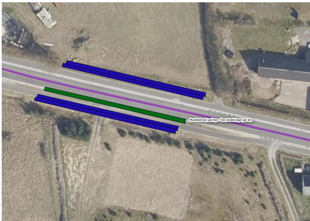
Figur 5 – Eksempel på antal gange der skal køres langs en vej. Blå = Yderrabat Grøn = Skillerabat mellem cykelsti og vej.
