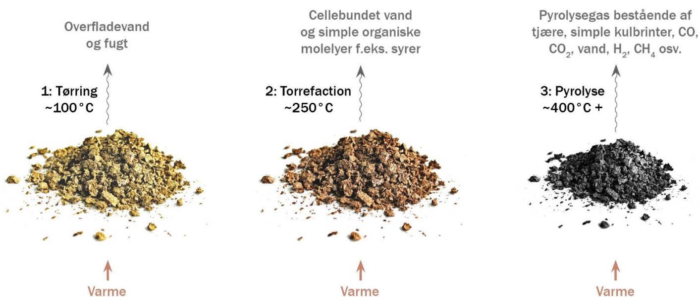
Figur 1: Illustration af effekten af at opvarme biomasse/organisk materiale i en atmosfære uden ilt. Egen tilvirkning.
