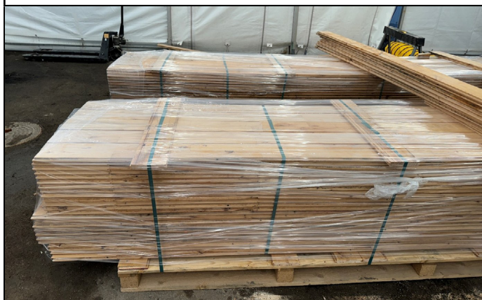
9. De rensede brædder pakkes på paller og wrap- pes i plastik.
