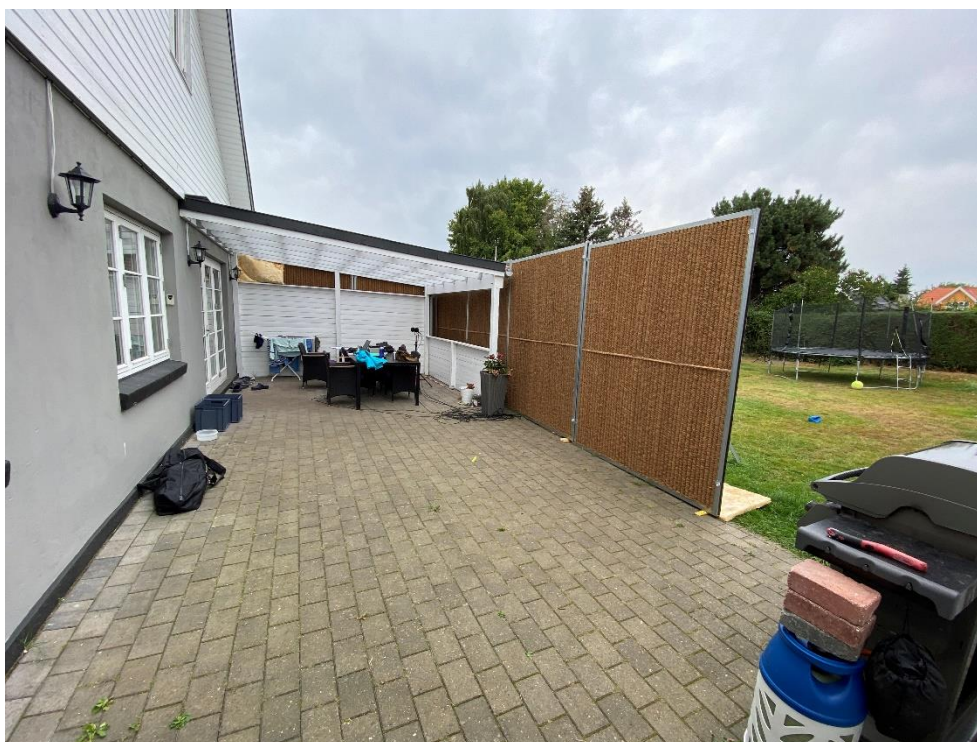
Figur 9 Bolig 1. Septembervej 126. Støjhegn i placering 2, højde = 2,5 m.
