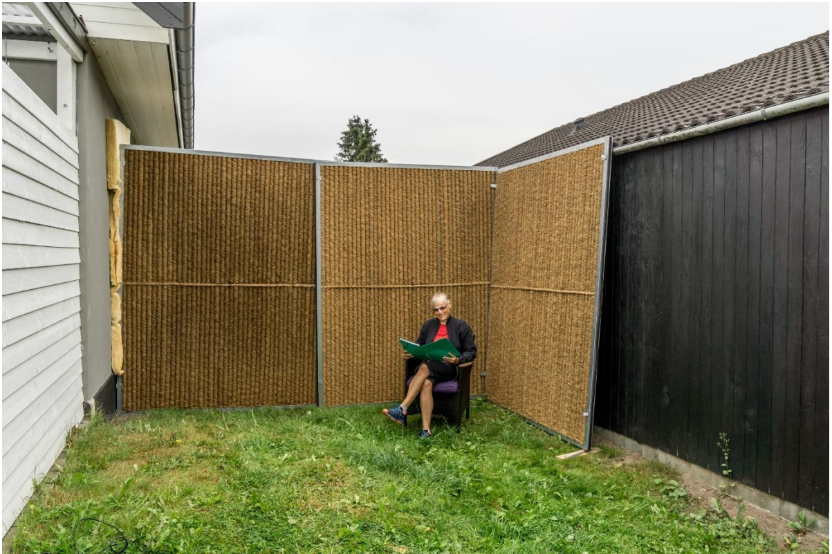
Figur 37. Opstilling, der lukker en åbning mellem to bygninger. Der er anvendt et støjhegn med en højde på 2,5 meter. På siddepladsen blev støjen dæmpet med ca. 4 dB. Det blev oplevet som en tydelig dæmpning.
