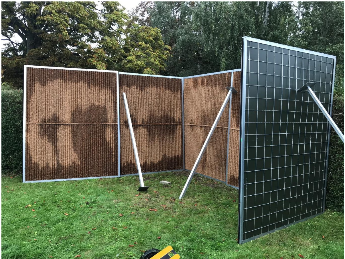
Figur 36. Samme opstilling som på Figur 34 og Figur 35 med et 2,5 meter højt støjhegn. Denne opstilling medførte stort set samme dæmpning som opstillingen med 2,0 meter støjhegn.
