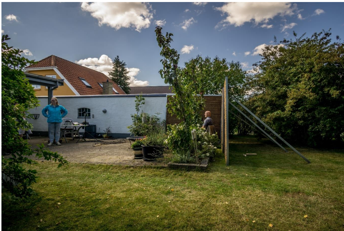
Figur 23. Denne opstilling er fra Augustvej, placering 2 i Forces rapport. Støjhegnet blev placeret længere væk fra huset, der ses til venstre, end de opstillinger, der er vist på Figur 19, Figur 20, Figur 21 og Figur 22. Ideen var at skabe en ny støjafskærmet siddeplads. Motorvejen ligger i fotografiets retning og afskærmes derfor i nogen grad af den hvide bygning. Der kom også støj fra højre, som blev afskærmet af støjhegnet. Hegnet på billedet var 2,0 meter højt.
