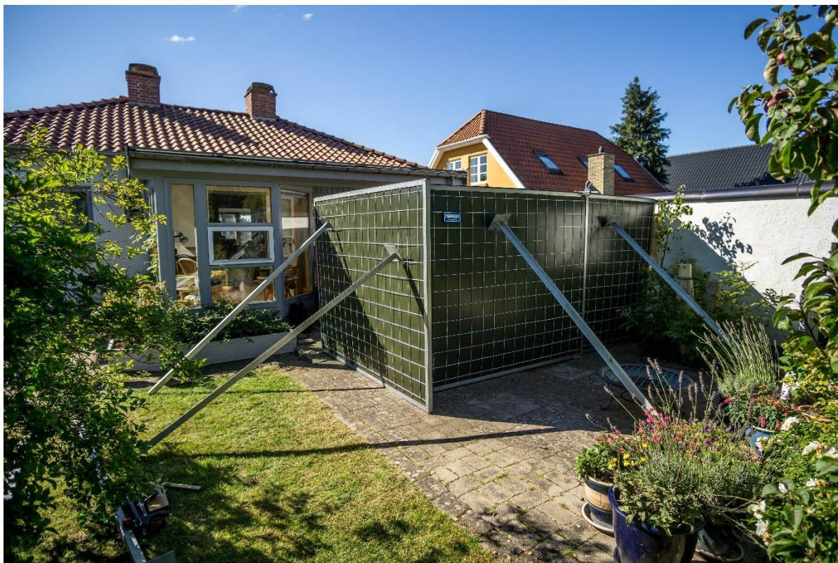
Figur 22. Samme opstilling som vist på Figur 21, men et 2,0 meter højt hegn set fra havesiden. Her blev opstillingen desuden forsynet med en vinge eller vinkel, der begrænsede åbningen mellem hegnet og bygningen. Der var dog fortsat god plads for passage mellem have og terrasse.
