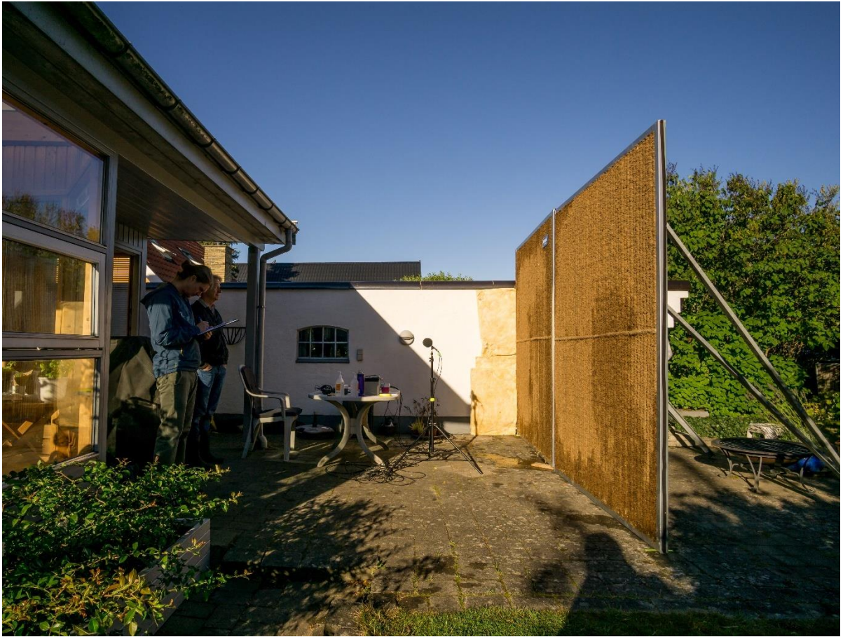
Figur 19. Den eksisterende terrasse strækker sig ud fra husets havestue til venstre og ud i haven mod højre. Den viste opstilling er 2,5 meter høj og havde til hensigt at skabe en støjbeskyttet krog foran havestuen, som i øvrigt også kan dæmpe støjen i havestuen, når døren er åben. Opstillingen stødte op til bygningen i baggrunden, som sammen med boligen var en del af den samlede løsning. Inde ved siddepladserne medførte denne løsning en støjdemping på ca. 4 dB, som en er tydelig dæmpning af støjen. Den subjektive oplevelse af løsningen var også, at støjen blev dæmpet mærkbart. Opstillingen er fra Augustvej, placering 1, højde 2,5 meter, uden vinge i Forces rapport.
