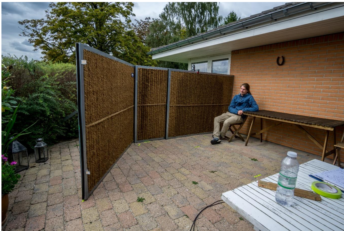
Figur 30. Samme opstilling som vist på Figur 29, men her med et 1,5 meter højt støjhegn. Det var den subjektive oplevelse, at støjhegnet medførte en mærkbar dæmpning af støjen. Den målte forbedring var 4 – 5,5 dB afhængig af siddepladsens afstand til hegnet. Det er interessant, at et 1,5 meter høje støjhegn i denne opstilling er lige så effektivt som et 2,0 meter højt hegn. Det skyldes formentlig, at opstillingen skaber en lille krog med støjhegnet tæt på siddepladserne. Den gode afskærmning i næsten alle retninger kombineret med siddepladser tæt på skærmen er vigtigere end den ekstra højde. Det er ikke nødvendigvis altid tilfældet.
