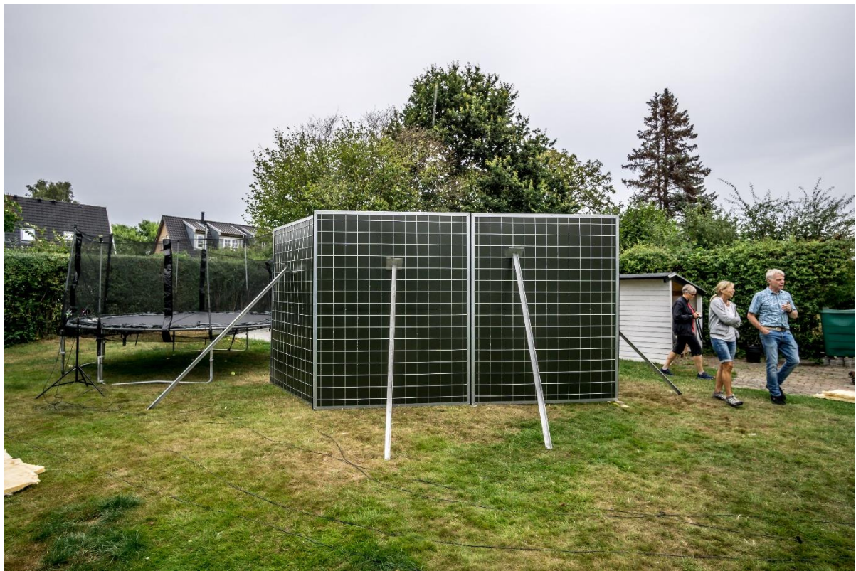
Figur 32. Opstillingen med et 2,5 meter højt støjhegn på Figur 31 er her vist fra den anden side. Hegnet har nogenlunde samme højde som trampolinen i baggrunden.
