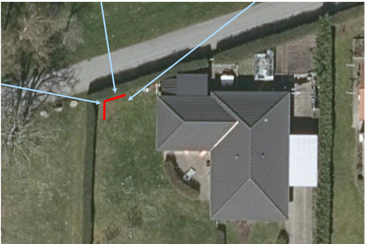
Figur 13 Når støjen fra den samme vej kan komme fra forskellige retninger, kan det være nødvendigt at et støjhegn har flere vinklede sider. I dette specifikke tilfælde kan en vinge i højre side betyde, at hegnets virkning forbedres, fordi den både dæmper støj fra højre og eventuel reflekteret støj fra boligen. Kilde til kort: Styrelsen for Dataforsyning og Effektivisering, https://sdfekort.dk/spatialmap .
