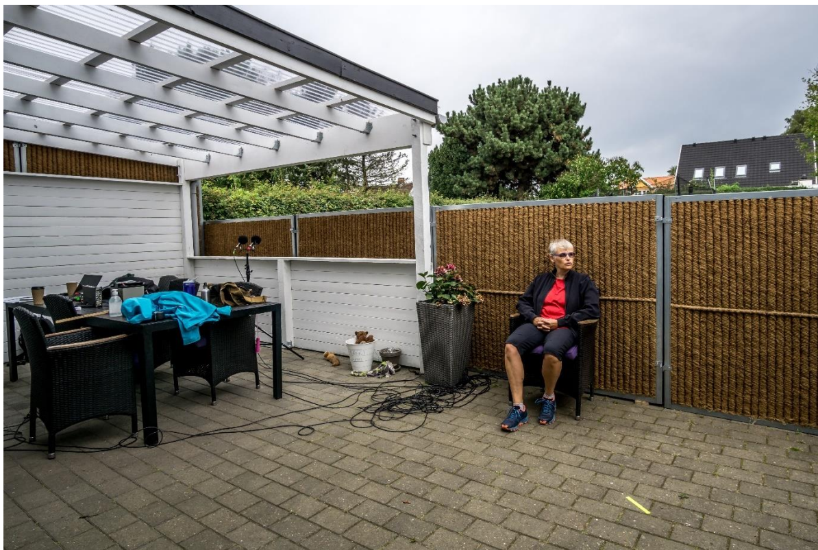
Figur 16. Denne opstilling er den samme som vist på Figur 15, men her med et 1,5 meter højt støjhegn. Helt tæt på hegnet, hvor personen sidder, blev støjen dæmpet med 5,5 dB, men med blot lidt større afstand, f.eks. på siddepladserne over halvtaget var den støjdæmpende virkning noget mindre. Opstillingen er på Figur 18 vist fra havesiden. Opstillingen er fra Septembervej, placering 2, højde 1,5 meter i Forces rapport.
