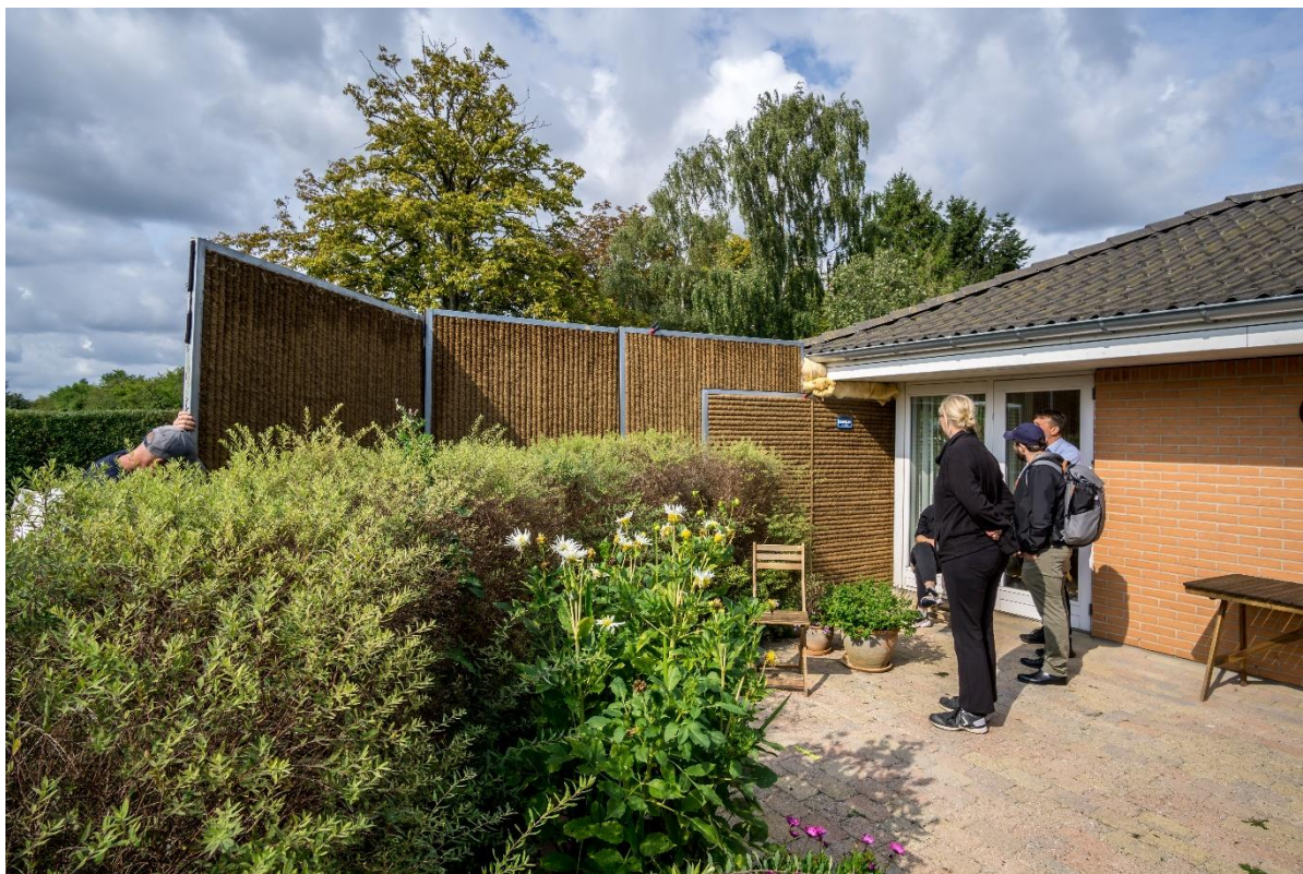
Figur 26. Denne opstilling med et 2,5 meter højt hegn har til hensigt at forbedre den støjafskærmende virkning, som huset bidrager til. Støjhegnet kan imidlertid dæmpe den støj, der kommer fra den retning, som på billedet er skjult bag hegnet og ikke er afskærmet af huset. På siddepladserne havde hegnet en støjdæmpende virkning på ca. 4 dB, derom også subjektivt blev oplevet som en mærkbar dæmpning. Det yderste lidt vinklede element medførte i denne opstilling en noget bedre dæmpning, op til 6 dB. Opstillingen er fra Bækkelunden, placering 2 i Forces rapport.
