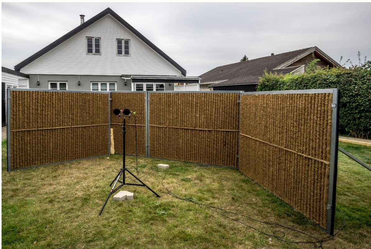
Figur 33. Samme opstilling som på Figur 31 med et 1,5 meter højt støjhegn. Den støjdæpende virkning var ca. 4 dB tæt på hegnet og ca. 2 dB ved den hvide flise i forgrunden, hvor måleudstyret er placeret på dette billede. Det blev oplevet som en mærkbar virkning med en opstilling, der var noget mindre visuelt dominerende.
