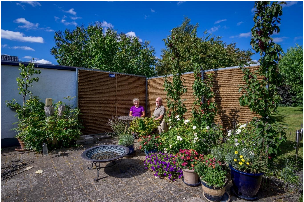
Figur 24. Samme opstilling som på Figur 23 med et 2,0 meter højt støjhegn. Opstillingen dæmpede støjen med ca. 4,5 dB på siddepladserne indenfor 1 meter fra støjhegnet. Hvis man sidder 2 meter fra hegnet, bliver støjdæmpningen mindre. Det skyldes formentlig støj, der kommer fra støjhegnets åbne side, i højre side af billedet. Den subjektive oplevelse af denne løsning var en betydelig og mærkbar dæmpning af støjen. Deltagerne i forsøget, inklusive beboerne, vurderede, at det var en god løsning; den dæmper støjen og kan visuelt indpasses i haven. En måling af hegnets virkning inde på terrassen nærmest udestuen, viste en støj dæmpning på 3 - 4 dB. Det er en overraskende høj virkning og den er formentlig meget afhængig af vindretning og retning til den støjende vej.
