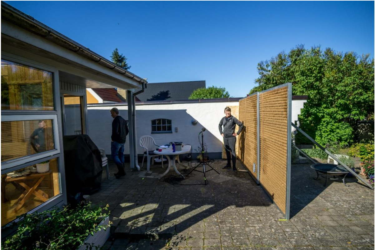
Figur 21. Samme opstilling som vist på Figur 19 og Figur 20, men med et 2,0 meter højt støjhegn. På siddepladserne blev støjen dæmpet med ca. 3 dB, hvilket kun er lidt lavere end den dæmpning, der opnås med et 2,5 meter højt hegn. Denne løsning dæmpede støjen med yderligere ca. 1 dB, hvis den blev forsynet med en vinge, som dækker det meste af åbningen mellem støjhegnet og udestuen til venstre. Som nævnt under Figur 20 kan den samlede støj dæmpning formentlig øges, hvis den hvide facade i baggrunden får en lydabsorberende overflade. Opstillingen blev også afprøvet med en højde på 1,5 meter. Med den løsning var støj dæmpningen lille og blev kun opnået helt tæt på hegnet. Den subjektive oplevelse er også, at det lave 1,5 meter høje støjhegn kun har virkning, når man sidder helt tæt på det.
