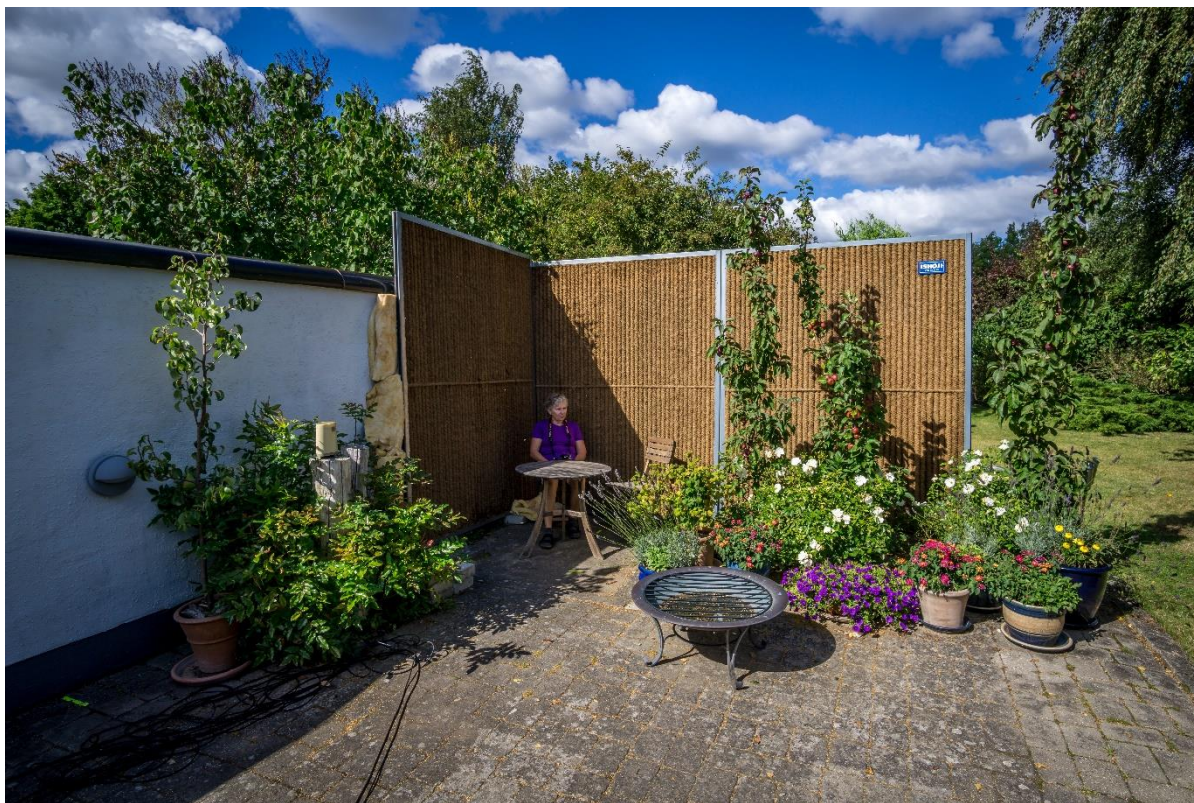
Figur 25. Samme opstilling som på Figur 23 og Figur 24, men med et 2,5 meter højt støjhegn. Det har en lidt mindre udstrækning mod højre (den lange side er 4 meter i denne opstilling, mod 5 meter i opstillingerne på Figur 23 og Figur 24). Det er interessant, at denne løsning havde en lidt mindre støjdæmpende virkning end opstillingen med et 2,0 meter højt hegn. Det skyldes formentligt, at hegnets udstrækning mod højre er kortere med det høje støjhegn. Det understreger, at man skal forsøge at få en god afskærmning af støj fra alle retninger.
