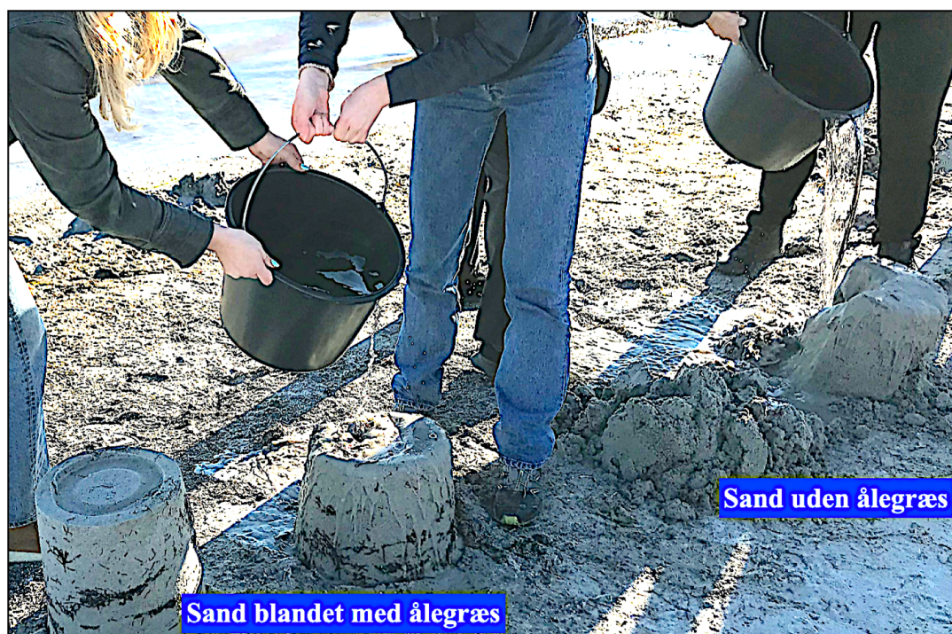
Figur 3. Ålegræs som strukturmateriale, der reducerer udvaskning/erodering af sand. Demonstration af effekten af ålegræs i Køge Bugt, april 2025.
