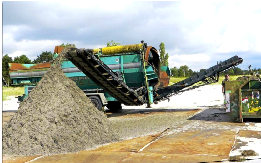
Figur 5. Rensning af tang med mobil tromlerenser. Se nærmere i bilaget.
