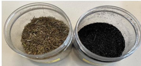
Figur 2. Bilden visar Bal med Ängsgräs från Malmö Stad längst till vänster. Krossat ängsgräs och gräsbiokol
