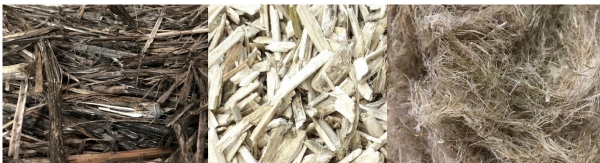
Figur 2.15. Till vänster hampestængler presset i baller. I mitten hampeskæver og till höger hampafibre. Her hamp fra Bio2Products forarbejdet ved DunAgro, Nederländerne. Foton: Bodil E. Pallesen.
