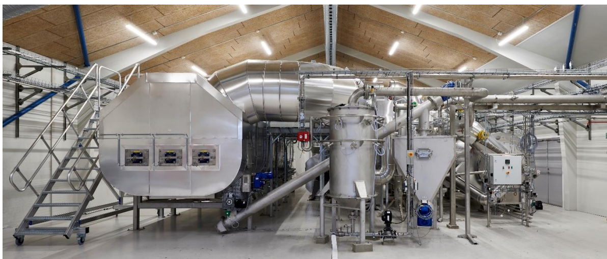
Figur 3.3. Danmarks første kommercielle pyrolyseanlæg til behandling af spildevandsslam. Bygget i Fårevejle af virksomheden AquaGreen.
