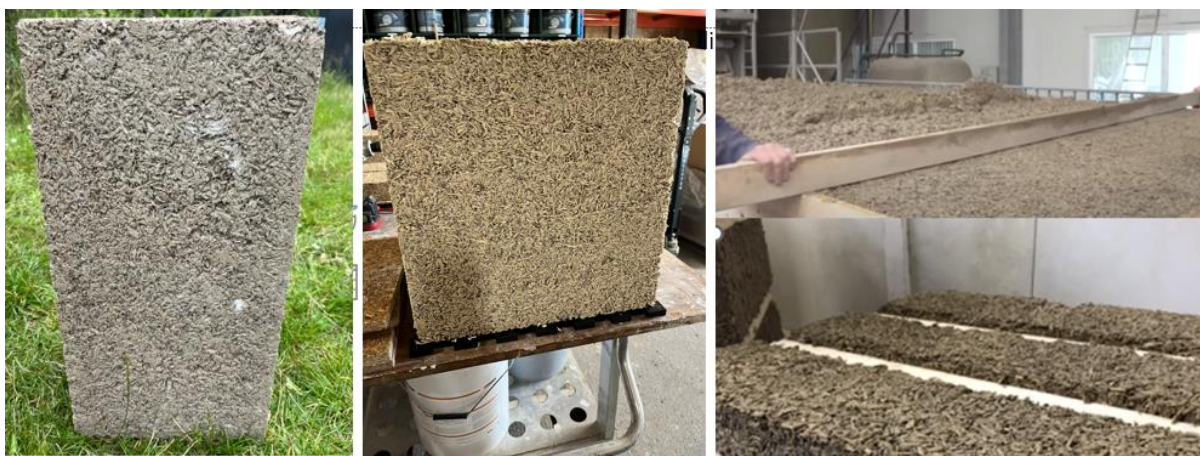
Figur 4.6. HempCrete – hampakalk-blokke fra forsøg hos Dansk Teknologisk Institut, 2024. Th. ses fremstilling af hempcrete elementer hos DunAgro, Nederländerne. Foto: Bodil E. Pallesen
