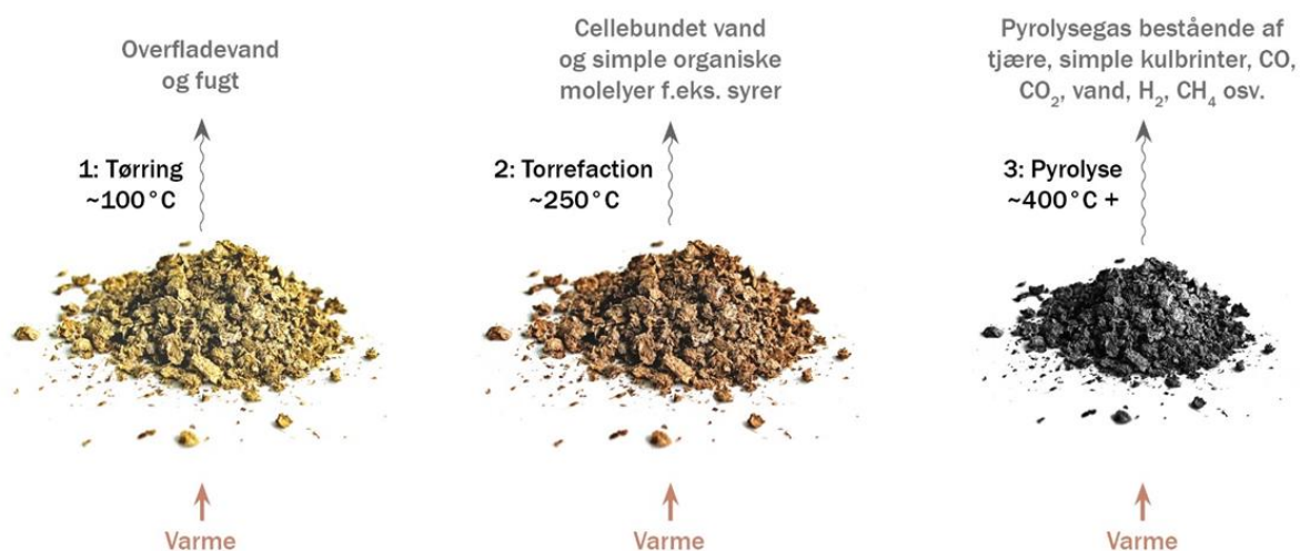
Figur 3.2. Illustration af den proces der sker når biomasse opvarmes til over 400 °C i en iltfattig atmosfære. Egen tilvirkning.
