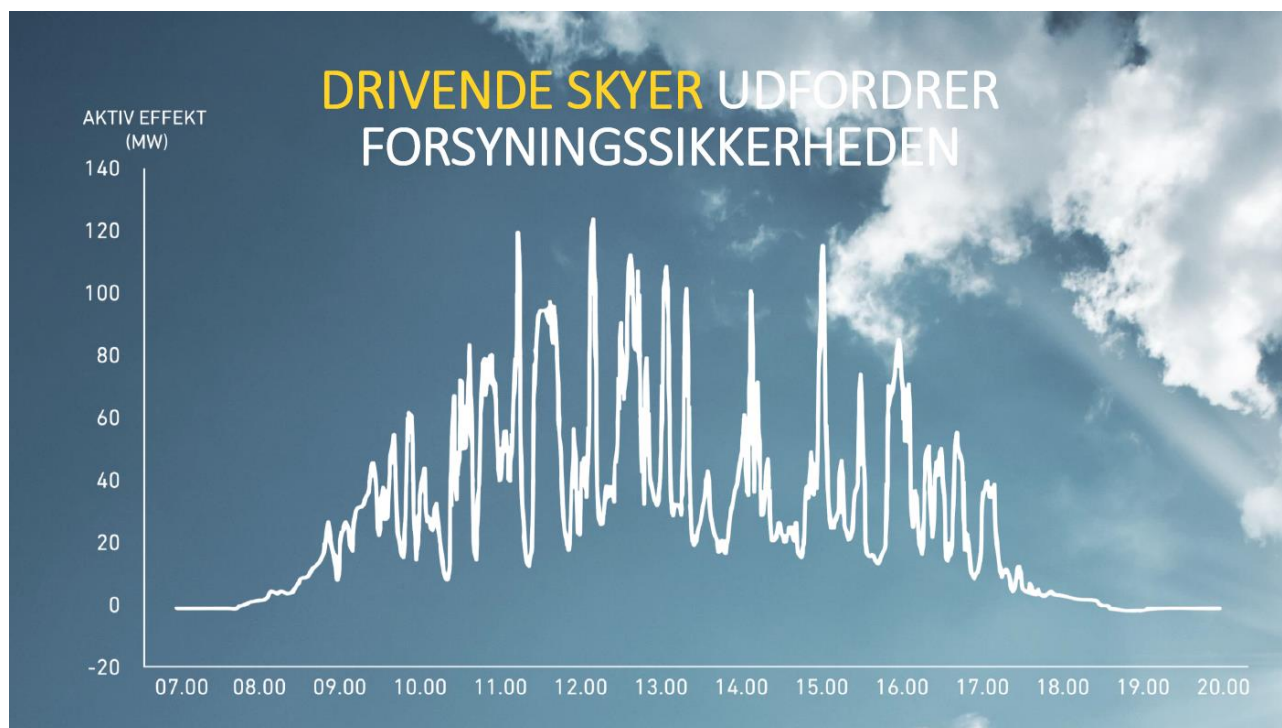
Figur 5: Input af solcellestrøm i elnettet en dag med vekslende skydække. Kilde: Energinet.dk
