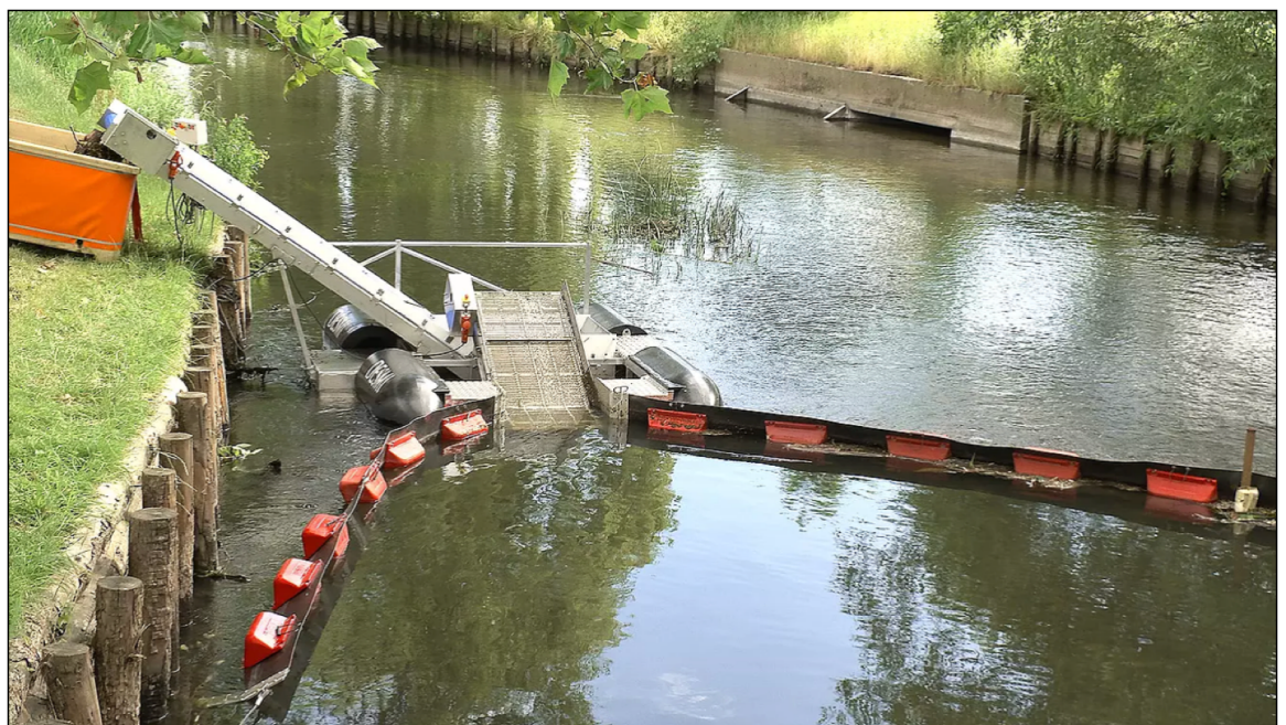
Figur 5: Flydespærringer, udviklet af Desmi, bl.a. til indsamling af tang. Her demonstreret i Odense år (flydespærring inklusiv opsamlingsaggregat).
